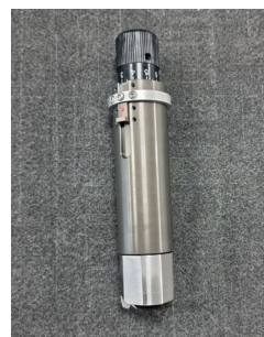
NÓŻ V-CUT cięcie tektury pod kątem
