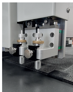
NÓŻ WLECZONY cięcie papieru, folii samoprzylepnej i magnetycznych, winyłu, nacinanie arkuszy pod naklejki
